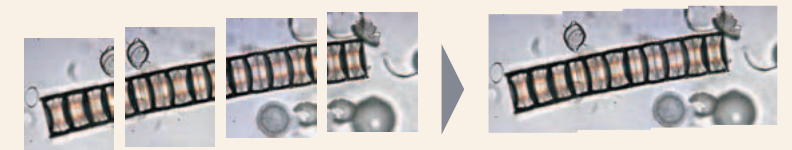
対物レンズ40×を使用して撮影した4枚の800×600pixelの画像合成例(サンプル:珪藻/生物顕微鏡で撮影)
