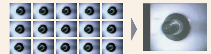
800×600pixelイメージ15枚の別焦点画像合成例(サンプル:ピス/実体顕微鏡で撮影)
